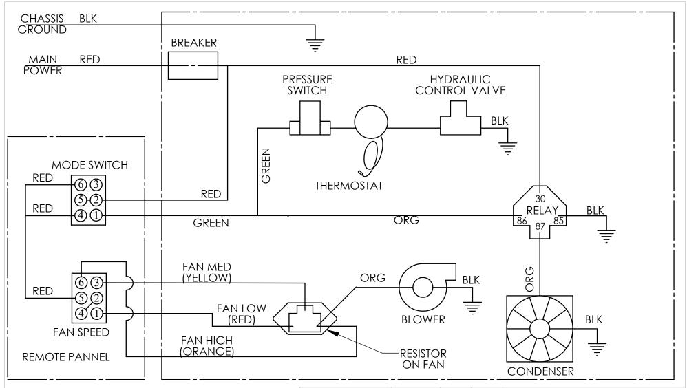
BREAKER AMP IS DIFFERENT DEPENDING ON VOLTAGE ON A 12 V SYSTEM BREAKER IS 40 AMP ON A 24 V SYSTEM BREAKER IS 20 AMP
